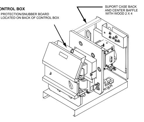
FIGURE F.5 - PROTECTION/SNUBBER BOARD LOCATION
